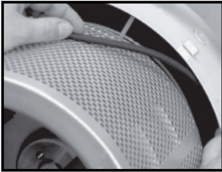
16. lépés. Szereljen be új tömítést.
