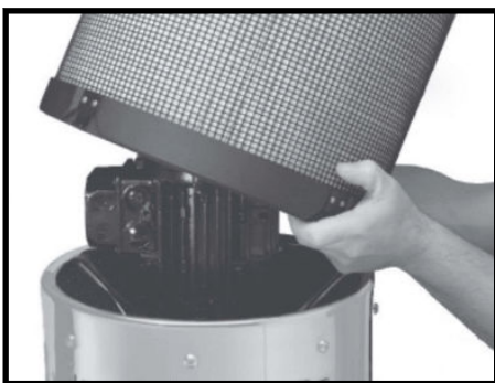
4. lépés. Ellenőrizze az utósűrőt (ha van felszerelve), és szükség esetén cserélje ki.
